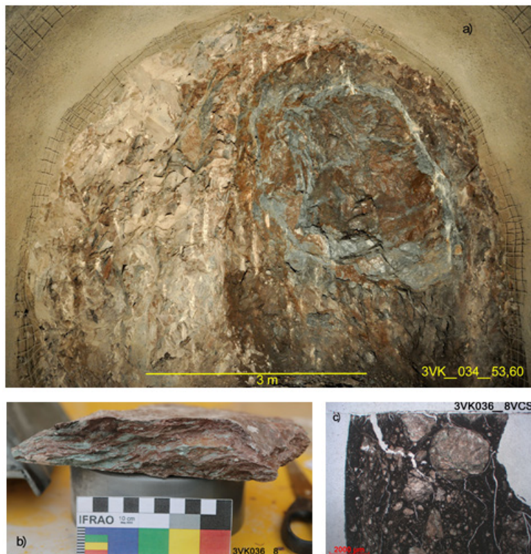
5. ábra. A Péter-törés anyagának jellemző képei különböző méretarányban (a- vágathomlok, b-kézipéldány, c-vékonycsiszolat)
