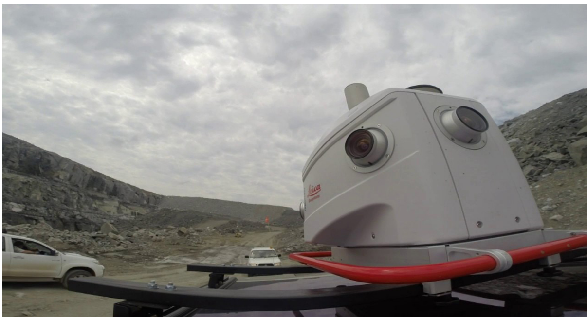
2. ábra. Mobil térképező rendszer bányafelmérés közben
