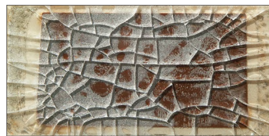
A vízfelvétellel duzzadó agyagkő szétrepesztí az üveglemezt, amelyre fölragasztották.
